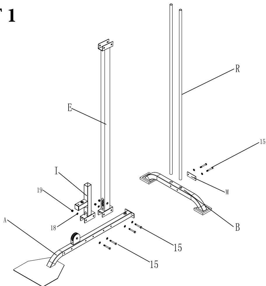
1. Прикрепите (B) к (A) с помощью (M) и болтов M10\*75 (15) + шайб 10 (18) + контргаяк M10 (19).
