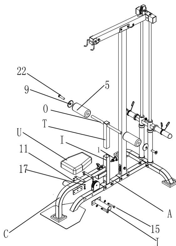
1. Прикрепите (Т) к (I) с помощью фиксатора (1).
